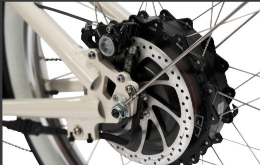
Radnabenmotor Go Swissdrive
