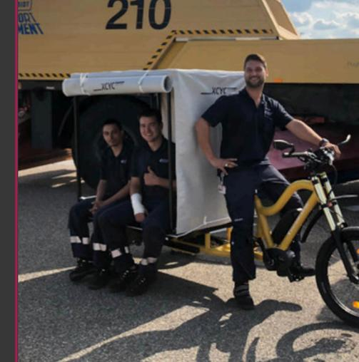
Das XCYC Work mit Planenaufbau wird am Flughafen Stuttgart für den internen Transport eingesetzt. Die E-Bikes unterstützen die Klimastrategie STRzero und werden von Mitarbeitern für den Transport von Werkzeugen und Materialien genutzt.
