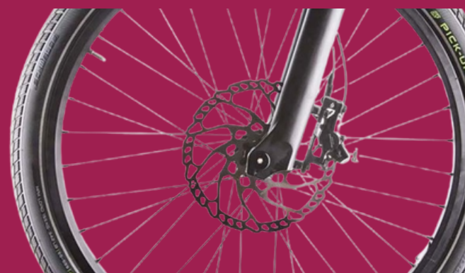
Scheibenbremsen kraftvolle hydraulische Shimano Scheibenbremse
