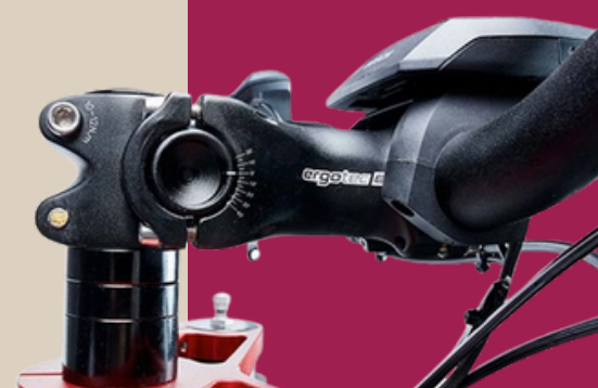
Lenkungsdämpfer stabilisiert das Fahrverhalten zusätzlich
